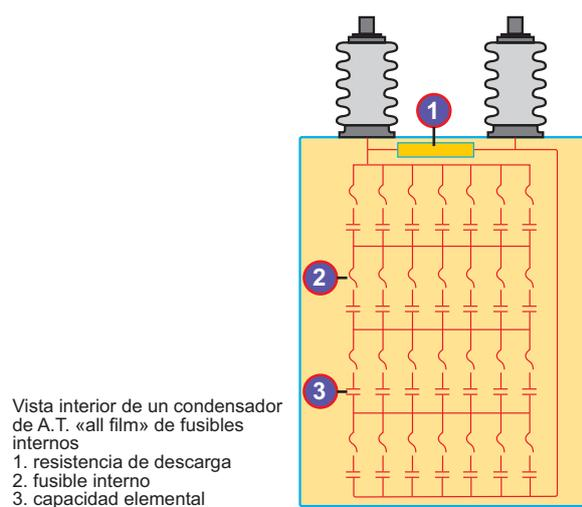
Vista interior de un condensador de A.T. «all film» de fusibles internos
